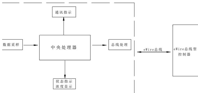
当空气中存在可燃气体时，探测器将采样值进行相应的处理，并将监测结果转换成总线信号显示或传送至控制器，同时接收并执行控制器的指令。
